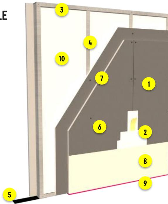
Pared interior compuesta por una estructura metálica sobre la cual se atornillan dos capas de placas Durlock® Extra Resistente por cara. Dentro de la cámara interior de 70mm se podrá colocar lana de poliéster.
