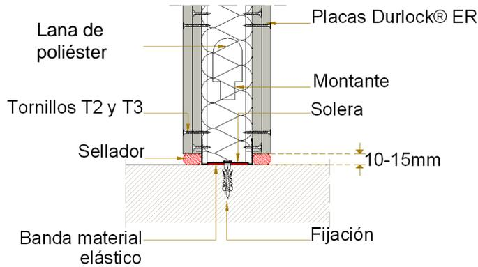
\* En caso de utilizar placas de 15mm de espesor, el Tornillo T3 se reemplazará por Tornillo T4.
