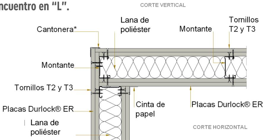
El perfil Cantenera podrá fijarse con tornillos T2 colocados con una separación de 15cm o con adhesivo de contacto. Luego recibirá dos manos de masilla Durlock®. En caso de utilizar placas de 15mm de espesor, el Tornillo T3 se reemplazará por Tornillo T4.
