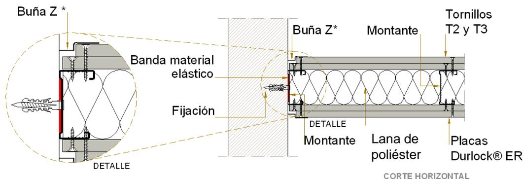
El perfil Buña Z podrá fijarse con tornillos T2 colocados con una separación de 15cm o con adhesivo de contacto. Luego recibirá dos manos de masilla Durlock®. En caso de utilizar placas de 15mm de espesor, el Tornillo T3 se reemplazará por Tornillo T4.
