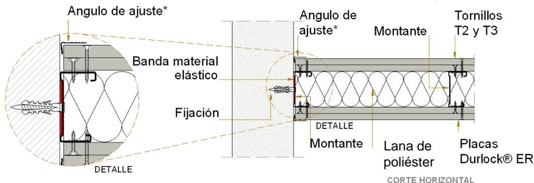
El perfil Angulo de ajuste podrá fijarse con tornillos T2 colocados con una separación de 15cm o con adhesivo de contacto. Luego recibirá dos manos de masilla Durlock®. En caso de utilizar placas de 15mm de espesor, el Tornillo T3 se reemplazará por Tornillo T4.
