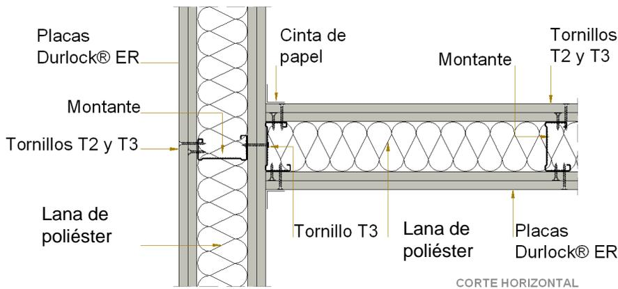
\* En caso de utilizar placas de 15mm de espesor, el Tornillo T3 se reemplazará por Tornillo T4.
