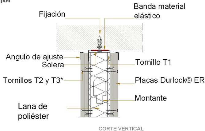
\* Los tornillos T2 se colocan a 50mm del borde de la placa., en caso de utilizar placas de 15mm de espesor, el Tornillo T3 se reemplazará por Tornillo T4.
